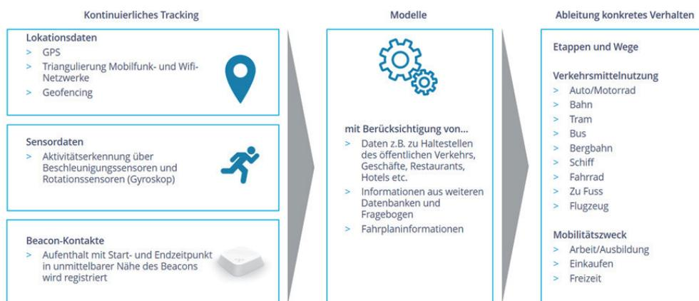
Abbildung 2: Messtechnologie und Datenaufbereitung
